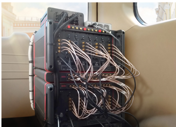
Рисунок 18. Измерительный комплекс Nemo Invex II, установленный в автомобиле.
